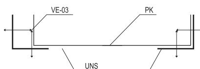
Spaja se s vanjske strane kabelskog kanala vijkom VE-03
